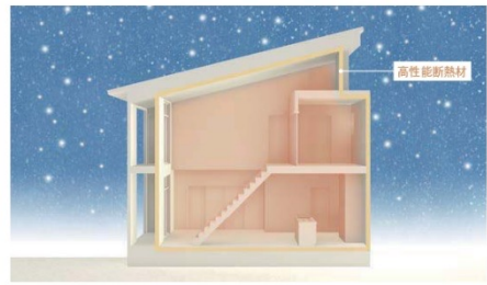
高断熱性能【熱損失係数(W/m 2 ·K)】⇨低 [ライフラインが断たれた時の暖房と室温低下の実態調査]より(2011.6 評論家 南塚三)
